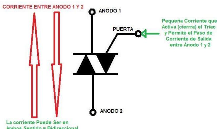
En el ánodo 1 y 2 se coloca el elemento de salida que queremos controlar con el triac (una lámpara, motor, etc.).
