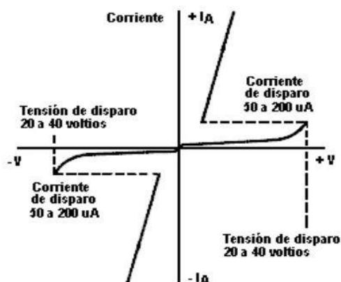
Lógicamente un triac no tiene solo una tensión de disparo, a partir de la mínima podemos activarlo con cualquier otra tensión o corriente por gate.
