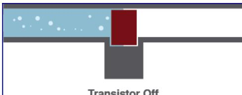
De la misma manera, un transistor puede ser utilizado para crear un **circuito abierto** entre los pines del colector y el emisor.
