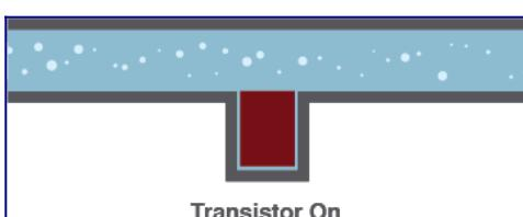
De igual manera, bajo las circunstancias correctas, un transistor puede parecer un **corto circuito** entre los pines del colector y el emisor. La corriente puede fluir libremente a través del colector, y salir por el emisor.
