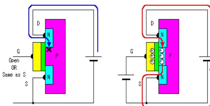
**En el mosfet su activación es por tensión**, se activa cuando ponemos a una tensión mínima en la patilla del transistor llamada Gate.
