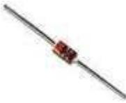
Recordemos que los diodos comunes, como el diodo rectificador (en donde se aprovechan sus características de polarización directa y polarización inversa), conducen siempre en el sentido de la flecha.
